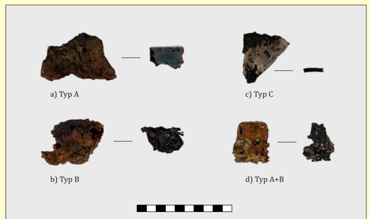
Abb. 2: Schlackentypen: a) Laufschlacke, b) Blasen- und Plattenschlacke, c) Plattenschlacke, d) Kombination aus Lauf- und Blasen- und Plattenschlacke
